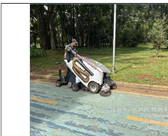
Figura 183: Varredeira Elétrica em Operação.
